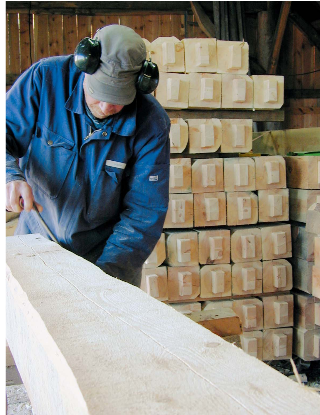
Tillaging av veggstolper med taper.
