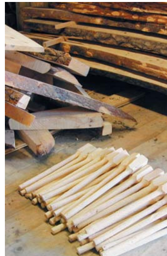
Krumvokste emner omformes til spant og stevner. 950 kg bly støpes til ballastkjøl. Monteringen kan starte.
