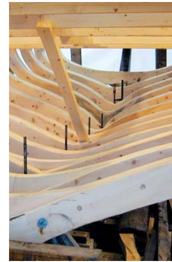
Spantene er kopiert fra 1:1 tegninger, montert på eikekjølen og blir slettet før hudplank stikkes ut, steames og monteres.
