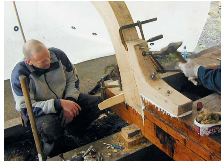
Krumvokste emner omformes til spant og stevner. 950 kg bly støpes til ballastkjøl. Monteringen kan starte.
